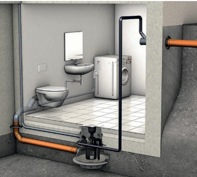
Abb. 41 – Funktionsprinzip einer Hebeanlage
